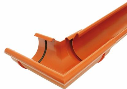
Угловые элементы и муфту желоба соединяем с желобом вдавливая передний заокругленный выступ желоба в муфту, а дальше заднюю часть желоба защелкиваем. Края желоба должны находиться **около 5 мм перед ограничителями.**
